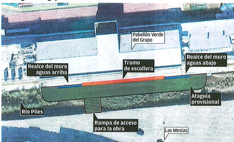
un vuelco parcial. El muro tenía tres grietas: al inicio, al final y en el punto medio del descalce. Recientemente se colocaron en estas grietas varios testigos para comprobar si la estructura se desplazaba. Varios de estos testigos han aparecido
