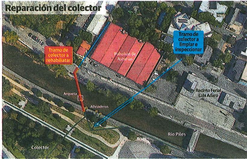
pieza e inspección de las conducciones a reparar mediante un camión de impulsión y succión. También se actuará sobre una arqueta ciega situada en el río para sellar las filtraciones existentes y generar una losa continua con el tubo con el propósito de demoler la falsa estructura existente. Otras actuaciones a acometer son la impermeabilización desde el interior de las arquetas con resina epoxi y fibra de vidrio, a lo que se unirá la instalación de sensores para determinar cau-
